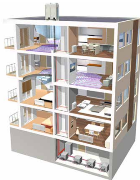
Figura 3.14 Instalación centralizada de calefacción y ACS con bombas de calor en un edificio de viviendas.
