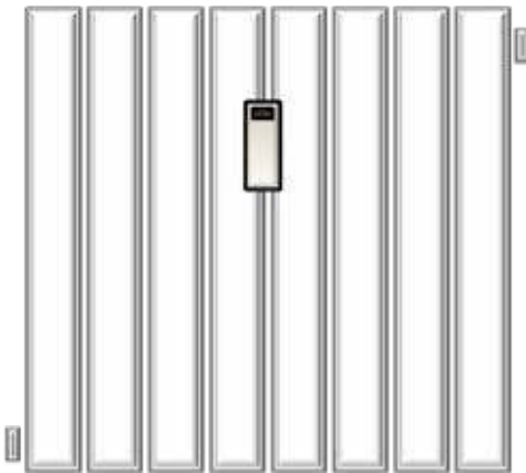
Figura 2.7. Aspecto de un repartidor de costes montado sobre un radiador.
