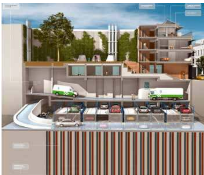
Figura 3.45 Captación de calor del subsuelo mediante sondas geotérmicas. Fuente: ANESE; Eneres.
