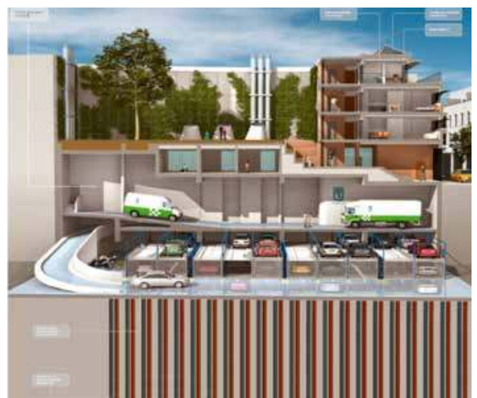
Figura 3.45 Captación de calor del subsuelo mediante sondas geotérmicas. Fuente: ANESE; Eneres.
