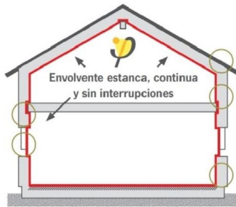
Figura 13. Esquema “regla del lápiz” PassivHaus (Fuente: Medgón PassivHaus)
