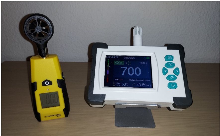
Figura 3 Modelo de medidor de CO 2 y anemómetro (Fuente: Luis Jiménez López)
